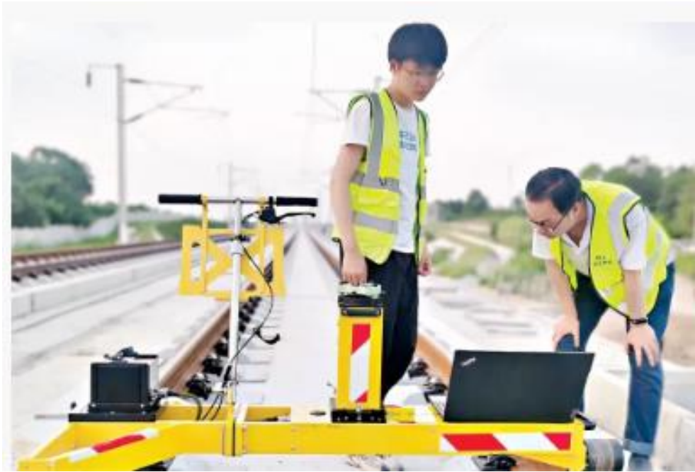
图 3 - 5 校企联合研发智能化铁路界限测量系统
