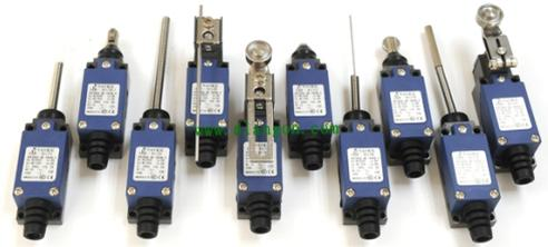
通过对三相异步电动机基本控制单元的分析，介绍极限限位开关的作用及接入方式，强调到“限位”必须“停止”的设计理念；说明“极限限位开关”必须以“停止按钮”的形式出现在控制回路中（使用其常闭触点，串接于停止按钮回路），通过“位置”控制“极限限位开关”的动作。
