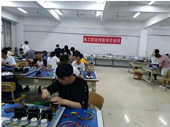
**实战训练 2:** 在前述基础上，接通主回路电源，先用正向控制按钮（SB2）控制电动机正转，观察电动机动作及方向，按下停止按钮（SB1）使电动机停止；然后用反向控制按钮（SB3）控制电动机反转，观察电动机动作及方向，按下停止按钮（SB1）使电动机停止。
