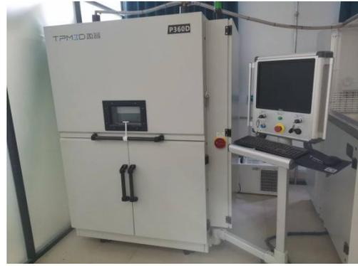
工业级 SLA 型 3D 打印机
