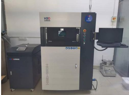
工业级 SLS 型 3D 打印机
