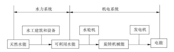
水轮机+水轮发电机=水轮发电机组(机组)
